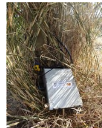
Figure 166 - Enregistreur automatisé de type SM2 installé sur l'aire d'étude - Photo in situ
